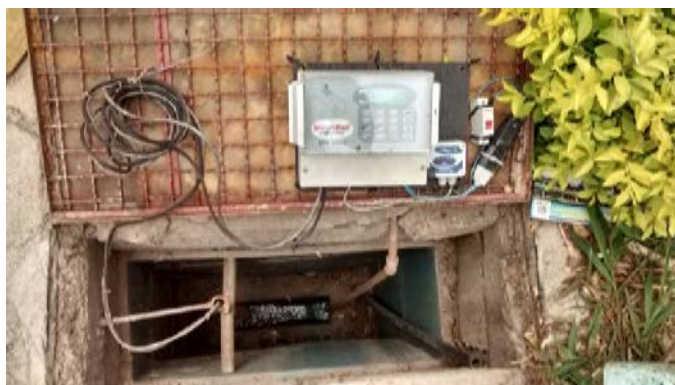
Figura 1: Vista superior do sistema: ponto de medição e amostragem composto pela calha tipo Palmer e Bowlus com transmissor e indicador de vazão por ultrassom e o Data-Logger
